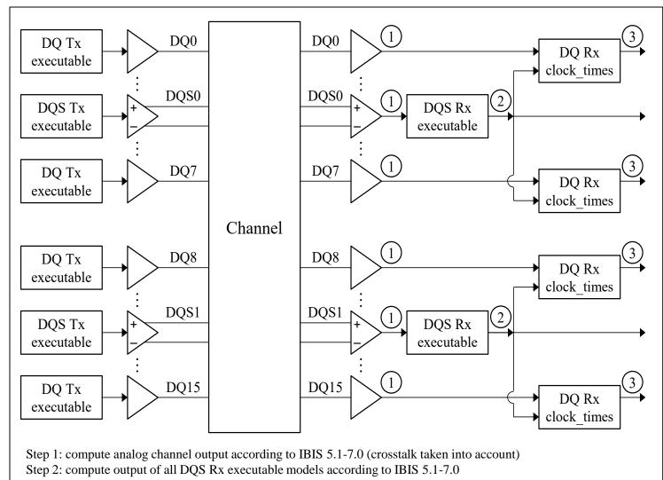
Use either DQS Rx clock\_times or wave output values as DQ Rx clock\_times input values
